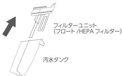
3. 汚水・ゴミを捨てた後水で洗い乾燥させる
