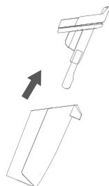
6. 汚水タンクの底部を本体に差し込み
